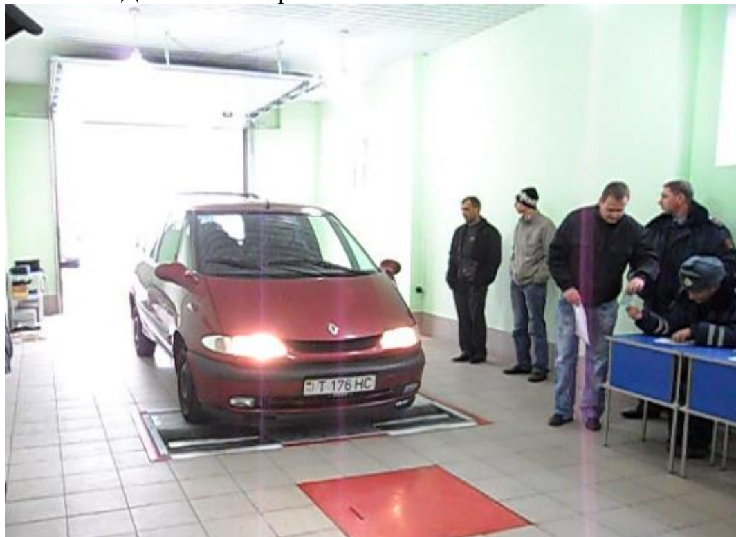
Рис. 1. Процесс исследования подвески автомобиля на диагностической линии «НУССБАУМ» 520 NTS
