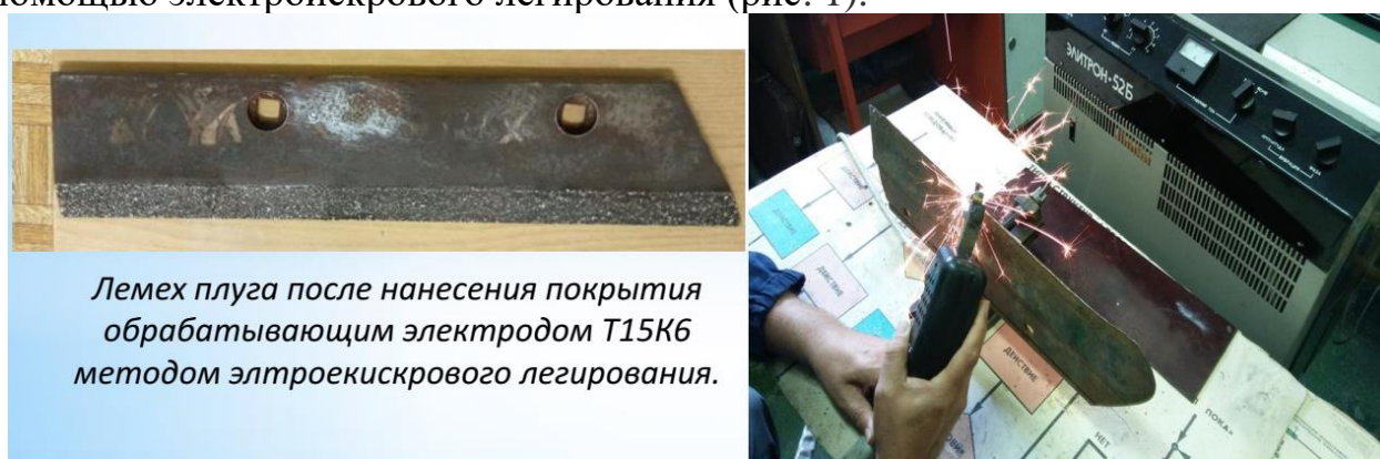
Рис. 1. Упрочнение экспериментальных образцов лемехов плуга ПСКУ-5 специальным сплавом Т15К6 с помощью электроискрового легирования
